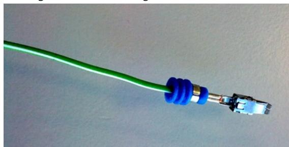
Lag en adapterkabel grønn/hvit (gn/ws) fra konverteringskitet
