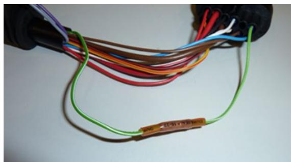
3. Koble adapterkabel fra konverteringssettet til med en skjøtehylse
