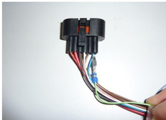
2. Sett kabelskoen til adapterkabelen inn i pin 12 og la den klikke på plass
